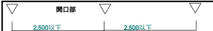
取付位置は 開口部の上枠 上部 150mm以内に設置します
