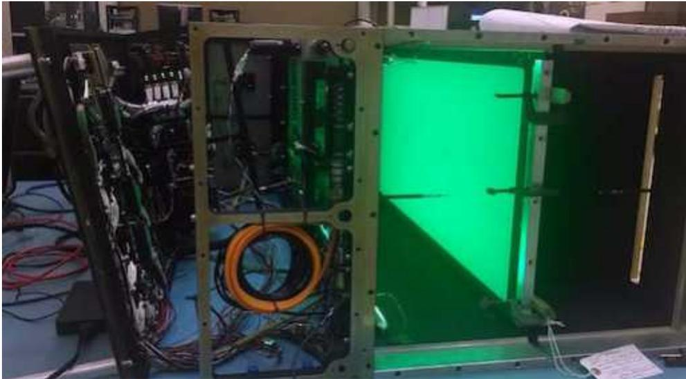
実験に使われた **Saffire-1** です。装置の内部には40×100センチメートルのコットン・ファイバーガラスと点火用のホットワイヤー、それに送風用のファンが備え付けられています。そして火災の様子はカメラで撮影され、地上へと送信される仕組みだそうです。
