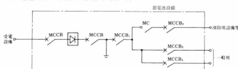
(注) 主遮断器MCCB<sub>1</sub>は過負荷及び短絡時にMCCB<sub>3</sub>、MCCB<sub>4</sub>より先に遮断しないものとする。
