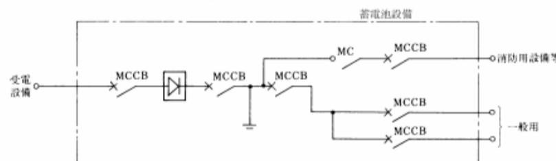
(注) 略号の名称は、MCCBは配線用遮断器をMCは電磁開閉器を示す。(以下同じ。)
