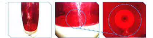
破断内圧=温度=約160℃ PENの融点=約280℃ 破断は考えられない粉々に砕けることがない
